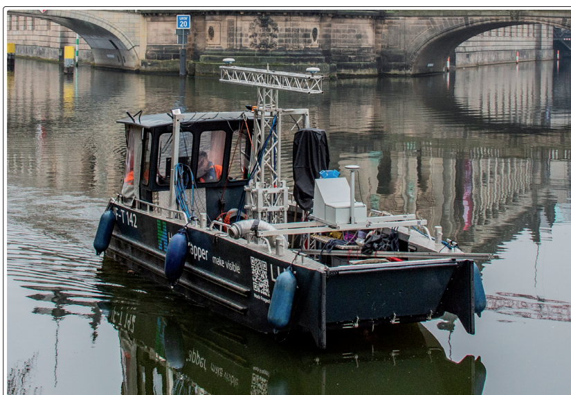
Abb. 1: Vermessungsboot LUX mit Multibeam-Echosounder, Profillaserscanner und Kamerasystem
