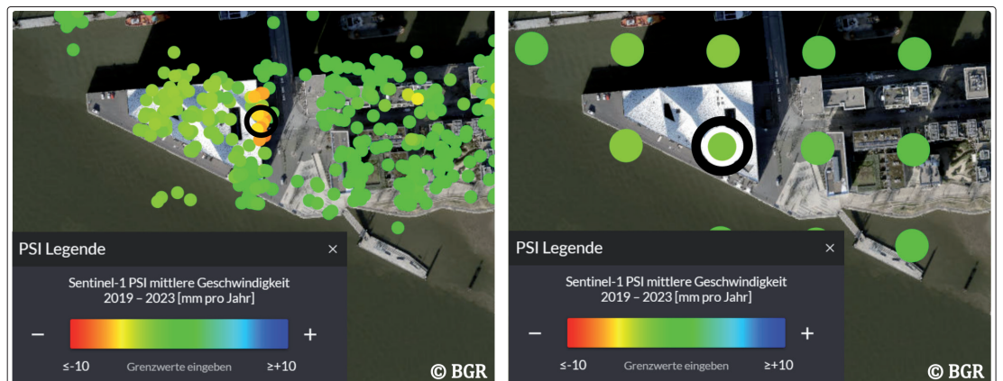
Abb. 4: Rückstreuer im Bereich der Elbphilharmonie in Hamburg. Links: Rückstreuer aus dem absteigenden Orbit. Rechts: Pseudomesspunkte aus der 2D-Dekomposition (Quelle: BBD). Die Zeitreihen der schwarz eingekreisten Rückstreuer sind in Abb. 5 abgebildet
