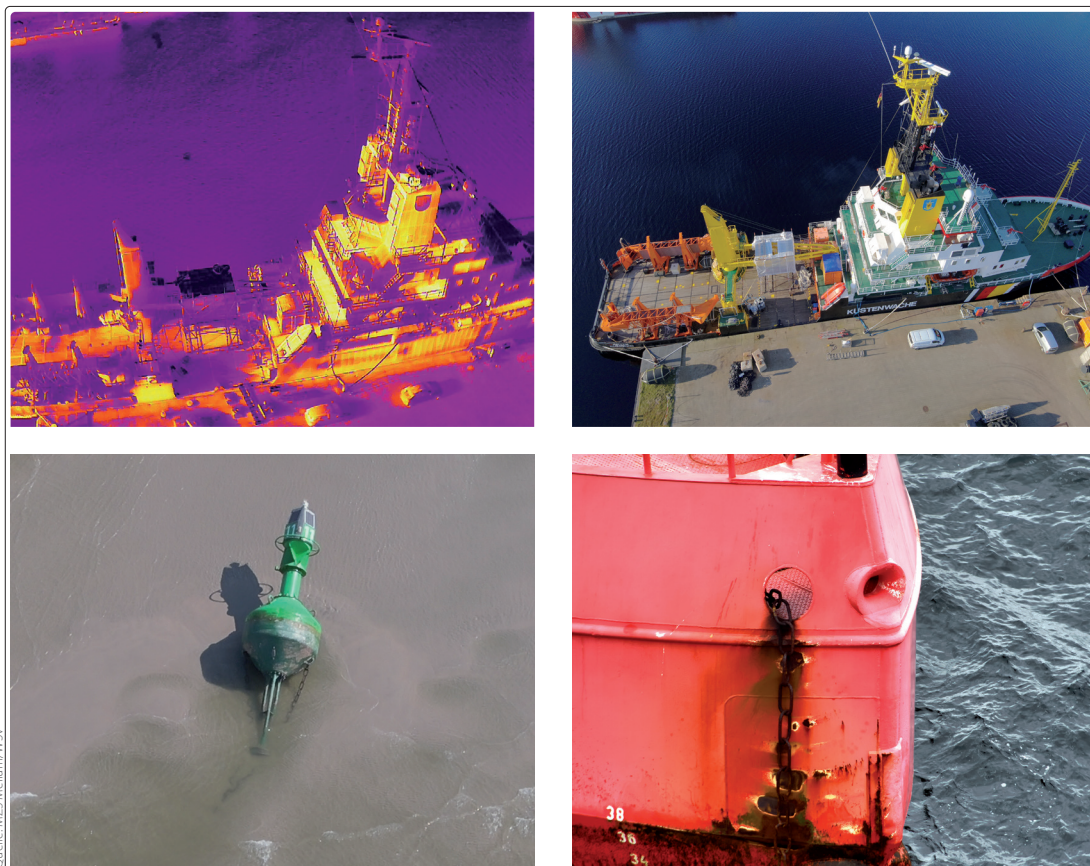
Abb. 1: Beispielbilder von UAS-Einsätzen von dem Mehrzweckschiff Mellum aus. Oben: Thermalaufnahme und Foto von der Mellum . Unten links: Erfolgreiche Suche und Begutachtung eines losgerissenen Seezeichens. Unten rechts: Zustandskontrolle einer Verankerung und Notschleppereinrichtung
