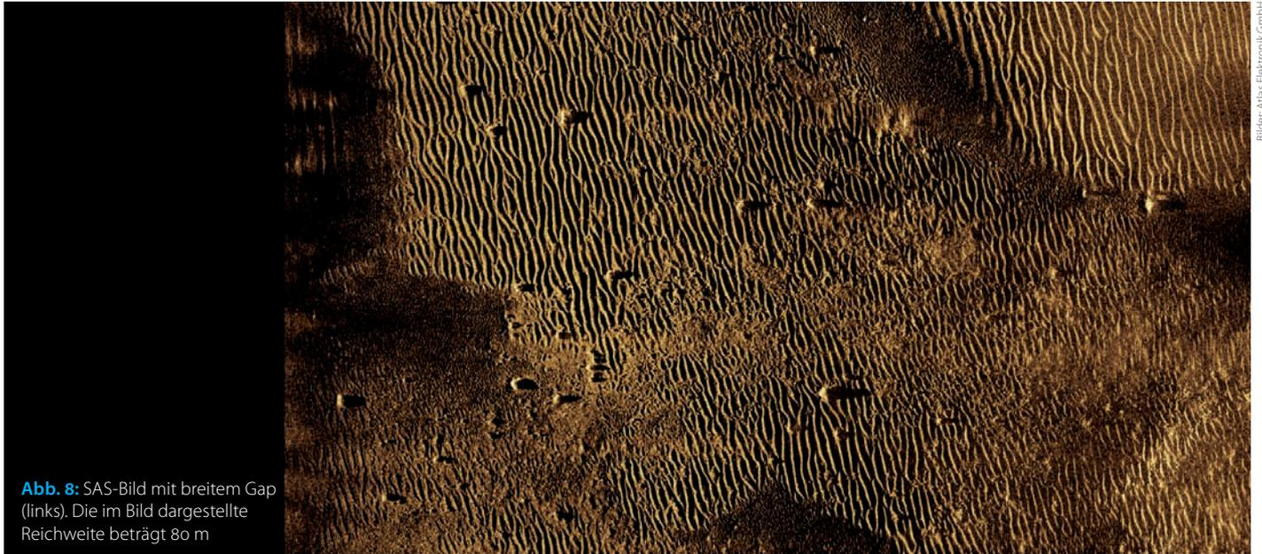
**Abb. 8:** SAS-Bild mit breitem Gap (links). Die im Bild dargestellte Reichweite beträgt 80 m
