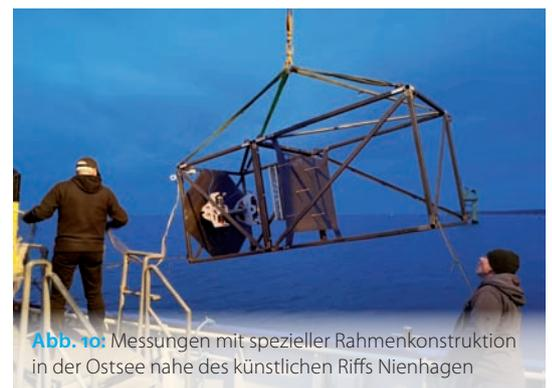
Abb. 10: Messungen mit spezieller Rahmenkonstruktion in der Ostsee nahe des künstlichen Riffs Nienhagen
