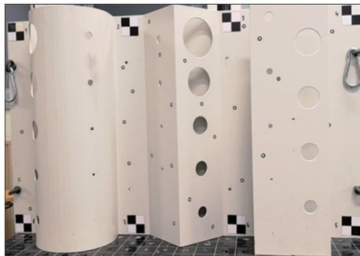
Abb. 1: Prüfobjekt mit offshoreähnlichen Strukturen
