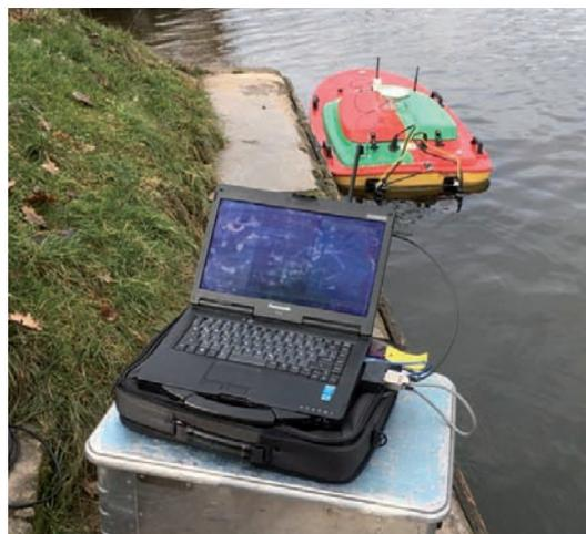
**Abb. 4:** Ferngesteuertes Boot mit Single-Beam-Echolot
