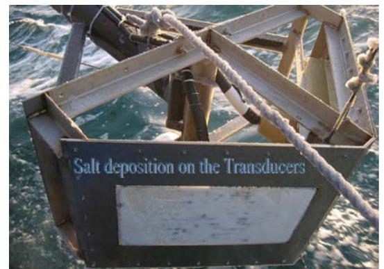
Abb. 3: Salzablagerungen auf der Schwingerfläche eines Fächerecholotes
