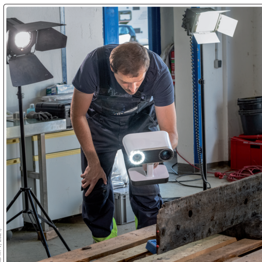
Abb. 14: Eine der eichenen Klinkerplanken wird mit dem Artec Leo-Scanner dreidimensional erfasst
