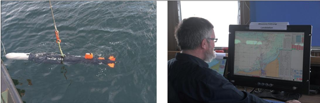
**Abb. 1:** Kampagne 2019 in der Ostsee: Set-to-work des autonomen Unterwasserfahrzeugs beim Trimmen im Hafen von Warnemünde (links) und Lagezentrum an Bord der *Deneb* (rechts)
