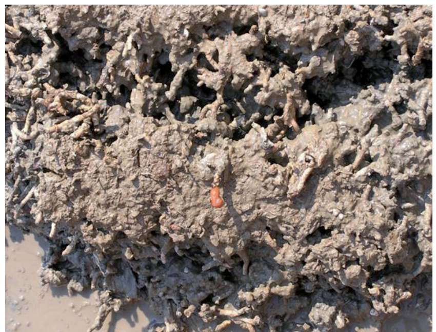
Abb. 1: Bodenprobe aus einem dichten Geflecht kalkiger Korallenröhren, das mit Schlick aufgefüllt ist
