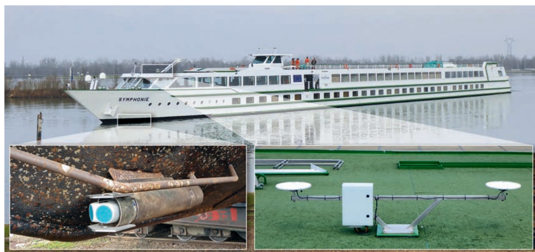
Abb. 1: Messtechnik an Bord des FGS »Symphonie«: Am Bug installiertes 2D-Horizontal-ADCP mit Halterung und Treibgutabweiser (links). An Deck installierte 2-Antennen-GNSS-Lösung zur Bestimmung der Position und Fahrtrichtung (rechts)
