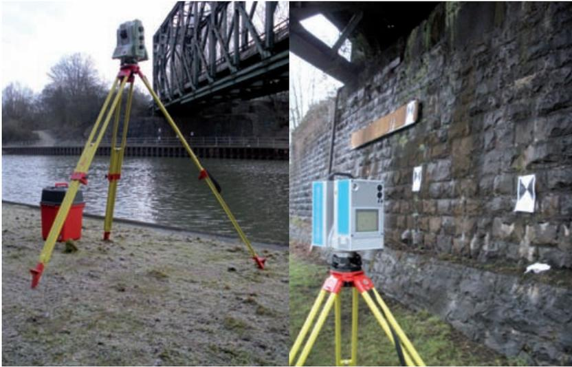
**Abb. 2:** Leica Nova MS 50 bei der Messung (links); Zoller + Fröhlich Imager 5010 C bei der Messung, im Hintergrund Papiertargets am Brückenpfeiler (rechts)
