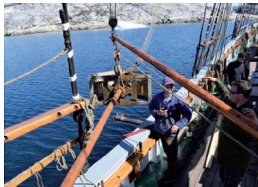
**Abb. 5:** Multibeam-Schwinger im Messeinsatz
