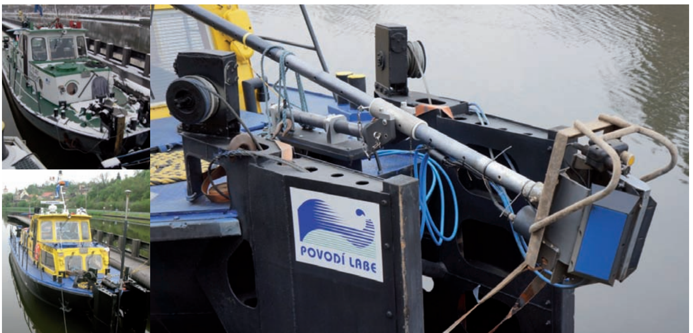
Abb. 3: Zurückziehbare Wanderhalterung. Auf der, durch eine Käfigkonstruktion geschützten V-Platte sind der Backbord- und Steuerbordschwinger sowie ein Kongsberg Seatex MRU-H-Bewegungssensor, eine Valeport Mini-SVS-Schallgeschwindigkeitssonde und ein Tritech PA200-20-Echolot angebracht. Die Schallwandler haben während des Einsatzes einen Tiefgang von 60 cm
