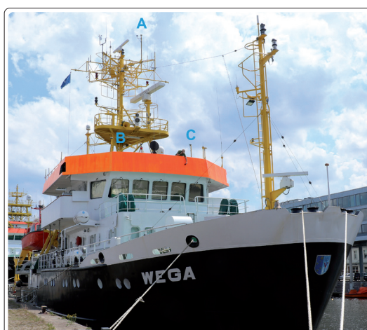
Abb. 1: Bild des VWFS WEGA im Hafen von Bremerhaven. Markiert sind die verwendeten Antennen. A – Mastantenne des Typs Leica AX1202 GG; B und C – steuerbordseitige bzw. backbordseitige Antennen auf dem Peildeck des Typs navXperience 3G+C
