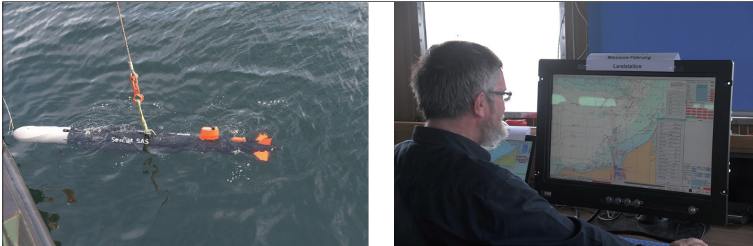
Abb. 1: Kampagne 2019 in der Ostsee: Set-to-work des autonomen Unterwasserfahrzeugs beim Trimmen im Hafen von Warnemünde (links) und Lagezentrum an Bord der Deneb (rechts)
