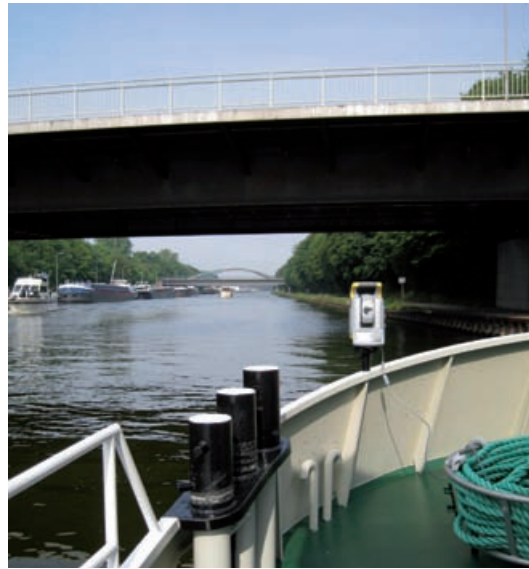
Abb. 5: Tachymeter an Bord von PS »Visurgis«
