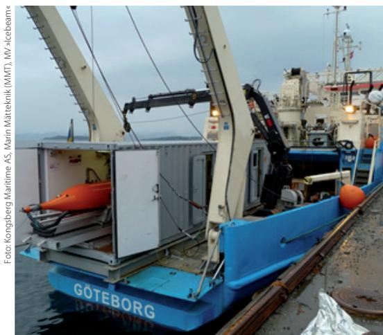
**Abb. 8:** MV »Icebeam« (Marin Mätteknik/MMT, Schweden) mit HUGIN-System
