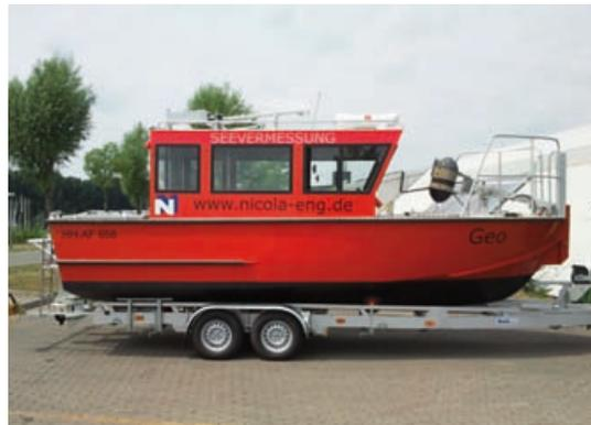
Ausgestattet mit zwei 50-PS-Außenbordern – um eine ausreichende Wendigkeit und Reisegeschwindigkeit (von 25 Knoten) zu erlangen –, einem eingebauten 2,2-kW-Generator und einem 120 Liter fassenden Tank, wiegt das Schiff samt der restlichen Ausrüstung nur 1,9 Tonnen und ist somit einfach per PKW-Trailer-Gespann zu bewegen.
