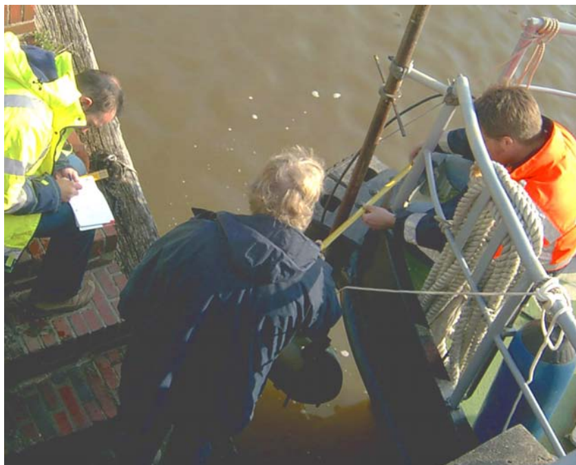
Abb. 3: Die Bestimmung der Ablagewerte des Fächerlotes zu den Motion- und Positionssensoren erfolgt nach der mechanischen Installation des transportablen Multibeam-Echolotes, das hier auf dem Foto noch nicht ins Hafengewässer abgeseut wurde
