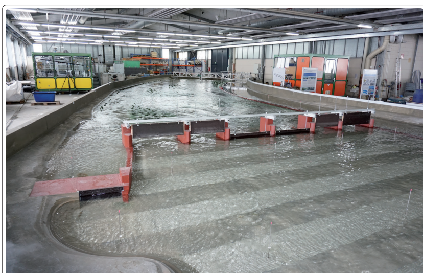
Abb. 4: Das gegenständliche Modell der Wehranlage Wieblingen im Maßstab 1:30. Blick vom Oberwasser auf die Wehranlage. Das Modell hat eine Gesamtlänge von ca. 70 m und eine Breite von ca. 10 m
