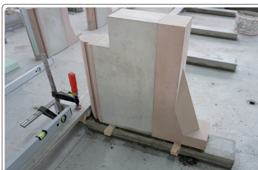
Abb. 9: Aufbau eines Modellpfeilers im gegenständlichen Modell Wieblingen
