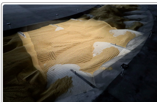
Abb. 3: Flussmodell mit beweglicher Sohle (Abstraktion eines freifließenden mäandrierenden Flusses) aus dem Jahre 2023 mit projiziertem Raster zur 3D-photogrammetrischen Aufnahme
