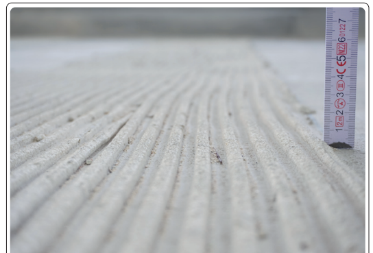
Abb. 12: Rauheitselemente im gegenständlichen Modell zur Erhöhung des Wasserspiegelgefälles im Oberwasser
