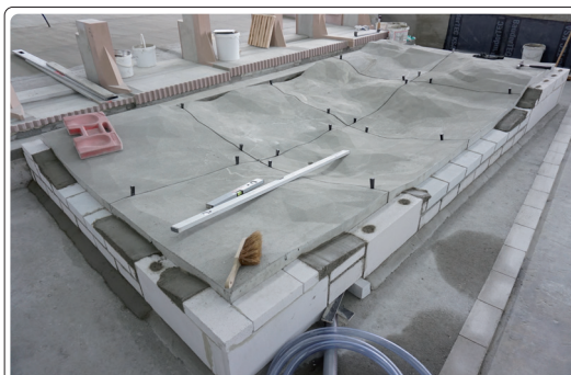
Abb. 8: Aufbau des gegenständlichen Modells Wieblingen: Einbau der Betongussblöcke im Bereich des Kolkes
