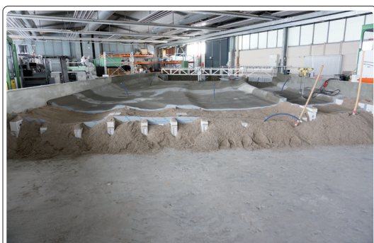
Abb. 7: Aufbau des gegenständlichen Modells Wieblingen: Profilierung des Unterwassers mit Hilfe von Querprofilen
