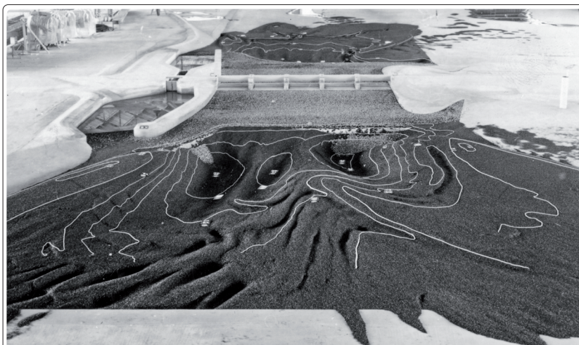
Abb. 2: Modell des Eidersperrwerks mit beweglicher Sohle aus dem Jahre 1995. Hier wurde die Kolkbildung im Unterwasser des Sperrwerks untersucht
