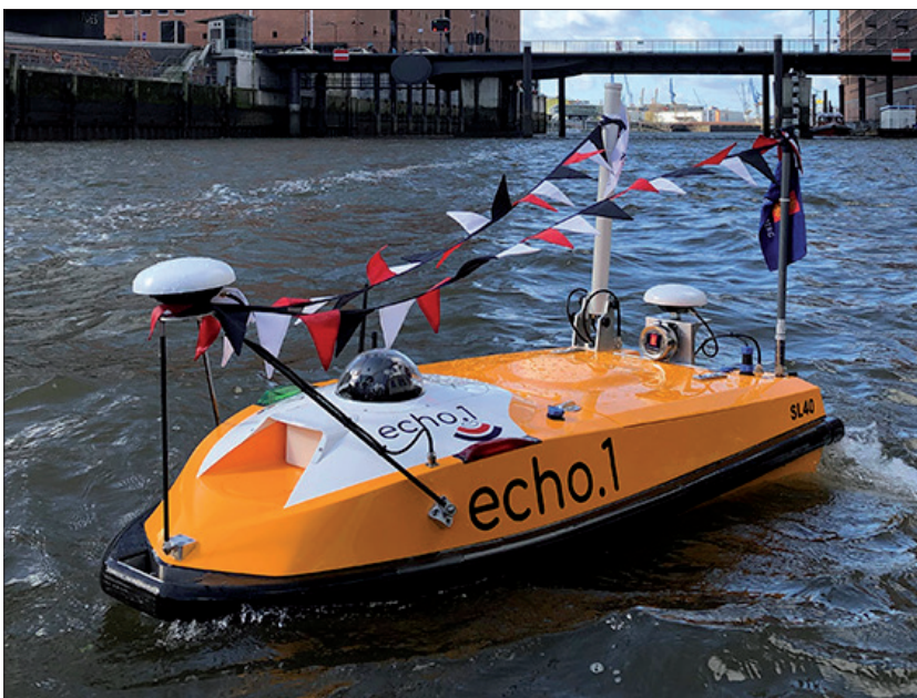
Abb. 2: Die Schwimmdrohne ECHO.1 für den Peil- und Vermessungsdienst im Hamburger Hafen
