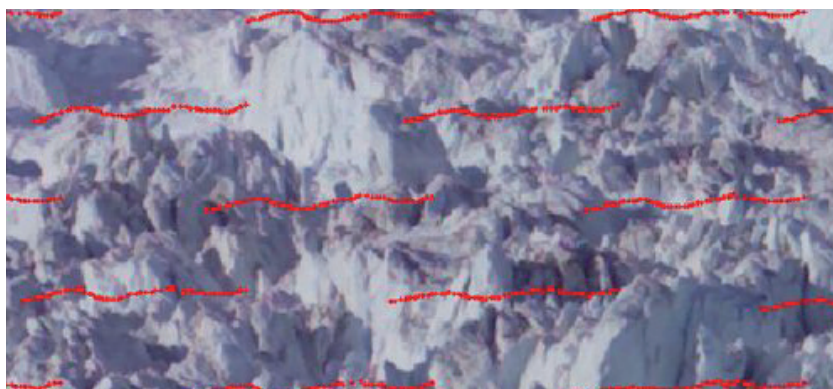
Abb. 6: Ausschnitt eines Geschwindigkeitsfeldes mit gezeiteninduzierter Vertikalbewegung
