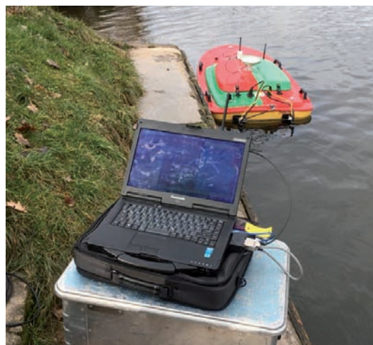
Abb. 4: Ferngesteuertes Boot mit Single-Beam-Echolot
